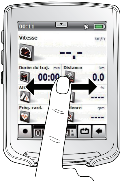
Illustration 6. Passer du mode Ordinateur de vélo au mode Carte, et vice versa
