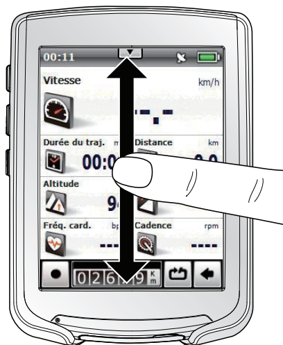
Illustration 5. Passer d'une vue à une autre sur l'ordinateur de vélo
